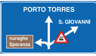
FIG. 240 ART. 127 SEGNALE DI PREAVVISO DI INTERSEZIONE EXTRAURBANA CON PASSAGGIO IN LINEA SU UN RAMO DELL'INTERSEZIONE
