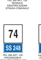
FIG. 266 ART. 129 PROGRESSIVA DISTANZIOMETRICA PER STRADA STATALE
